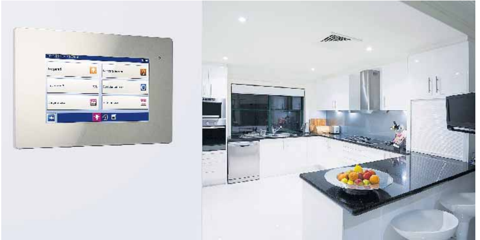
La pantalla táctil remota permite controlar todas las funciones. En la cocina, por ejemplo, se pueden programar alarmas técnicas o el encendido de electrodomésticos. :: SUR
